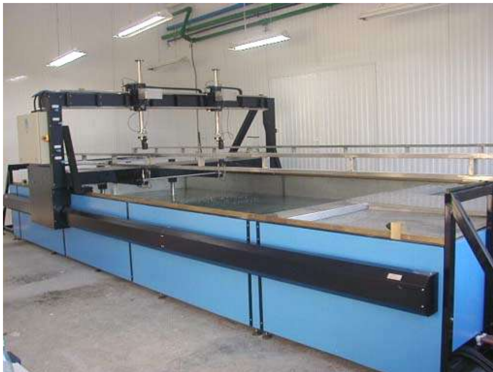
Fot. 2. System C-scan z wodnym sprzężeniem strumieniowym do badań zespołów kompozytowych techniką przepuszczania. Laboratorium PZL Świdnik S.A.
