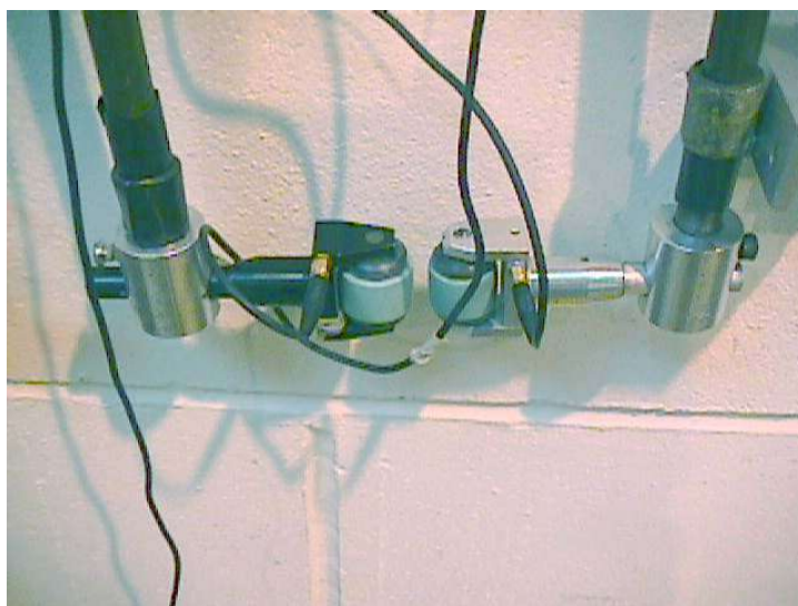
Fot.1. Układ głowic rolkowych do badań struktur przekładkowych techniką przepuszczania
